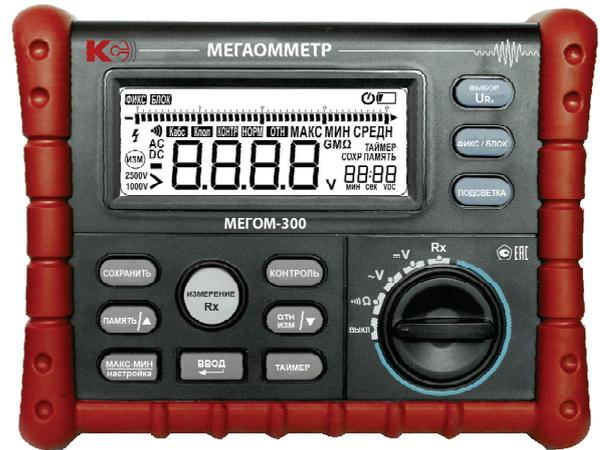
Цифровые мегаомметры МЕГОМ-300 торговой марки КС® предназначены для измерения электрического сопротивления изоляции постоянному току, напряжения постоянного и переменного тока, а также диагностики состояния изоляции электрических цепей, не находящихся под напряжением.
