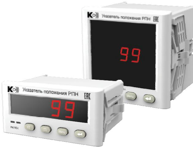
**Указатели положения** предназначены для преобразования сигнала датчика положения привода РПН трансформатора в цифровой код, отображения номера положения переключателя на отсчетном устройстве с последующим преобразованием в унифицированный выходной аналоговый сигнал, передачи результатов преобразования посредством интерфейса RS-485 (протокол Modbus RTU). Может применяться с любыми приводами с датчиками типа «токовая петля» и количеством ступеней до 99.
